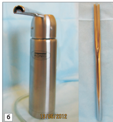
Рис. 3. Наконечники для криодеструктора: а — схема стандартного (1) и подковообразного (2) наконечников; б — наконечник в рабочем состоянии и в разобранном виде
