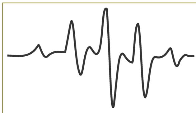
**Рис. 4.** Спектр электронно-парамагнитного резонанса типичных концевых макрорадикалов при полимеризации олигокарбонатметакрилата марки ОКМ-2
