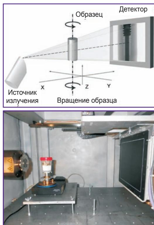
Рис. 1. Схема микро-КТ-сканирования с применением конического пучка острофокусного рентгеновского аппарата и регистрацией на плоскопанельном детекторе [16] и модель томографа «Орел-МТ» с размещенным объектом исследования
