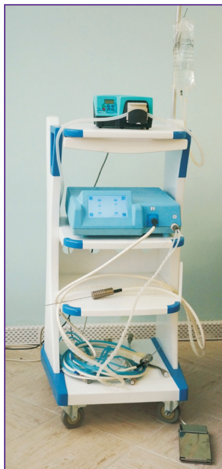
Рис. 1. Медицинский СВЧ-комплекс для термического воздействия на паренхиматозные ткани
