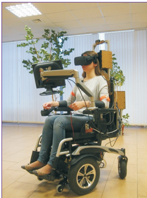
Рис. 3. Прототип интеллектуальной инвалидной коляски Оснащен ультразвуковыми дальномерами, видеокamerой, многоканальным контроллером моторов, контроллерами дальномеров. Работает под управлением компьютера с программным обеспечением на основе ROS. Дополнительно оборудован миографическими сенсорами, средствами вибротактильной коммуникации и очками виртуальной реальности
