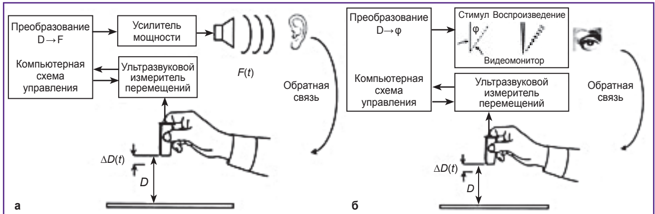
Рис. 1. Схема управления параметрами предъявляемых звуковых (а) и зрительных (б) стимулов с помощью бесконтактного манипулятора [1]
