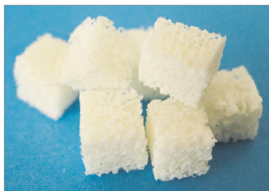
Рис. 1. Недеминерализованный костный коллаген в виде блоков 5х5х5 мм, используемый в качестве носителя ФРЭС
