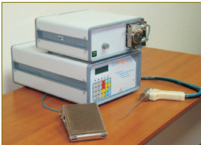
Рис. 1. Внешний вид комплекса для контактной СВЧ-деструкции тканей
