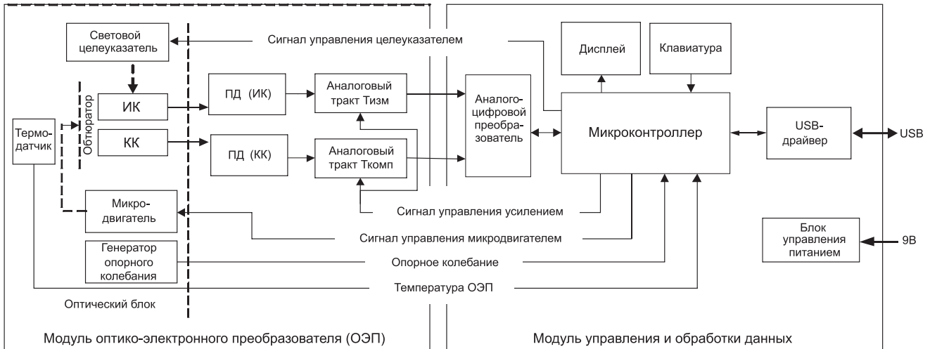
Рис. 1. Структурная схема ИК-радиотермометра: ПД (ИК) — пиродатчик инфракрасного канала; ПД (КК) — пиродатчик компенсационного канала
