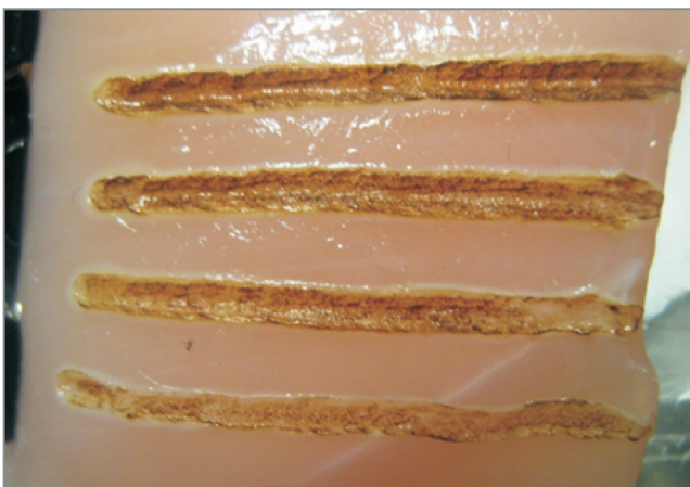
Рис. 3. Линейный разрез при действии лазерного излучения с длиной волны 810 нм на мышечную ткань курицы; мощность сверху вниз — 9, 7, 5, 3 Вт (макрофотография)
