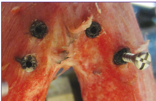
Рис. 3. Технология аутологичного модифицирования нетканого титанового материала со сквозной пористостью
