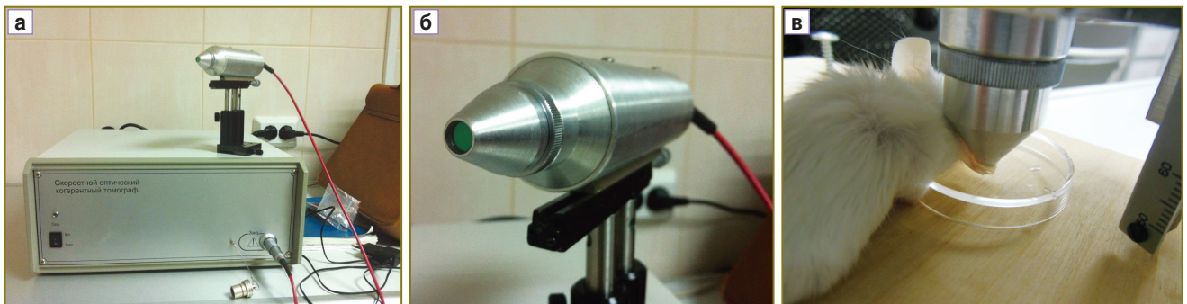
Рис. 1. Система для получения ОКТ-изображений: а — устройство многофункциональной ОКТ; б, в — ОКТ-зонд с торцевым окном
