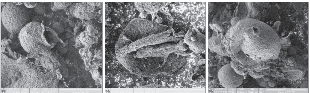
Рис. 7. Образцы микрокапсул из поли(3-гидроксибутирата) с инкапсулированным белком после проведения опыта in vitro в течение 200 ч по данным сканирующей электронной микроскопии
