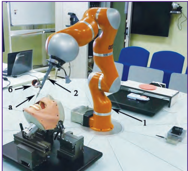
Рис. 1. Внешний вид манипуляционного робота для челюстно-лицевой хирургии:
