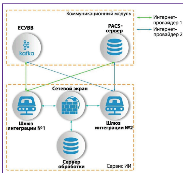
Рис. 9. Аппаратная схема интеграции с ЕРИС ЕМИАС
