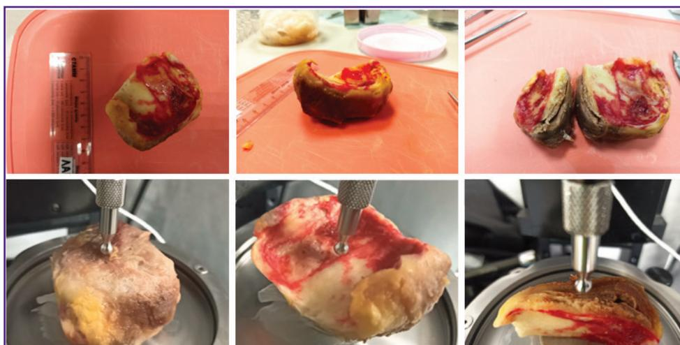
**Рис. 2.** Инструментальное индентирование образцов аорты
