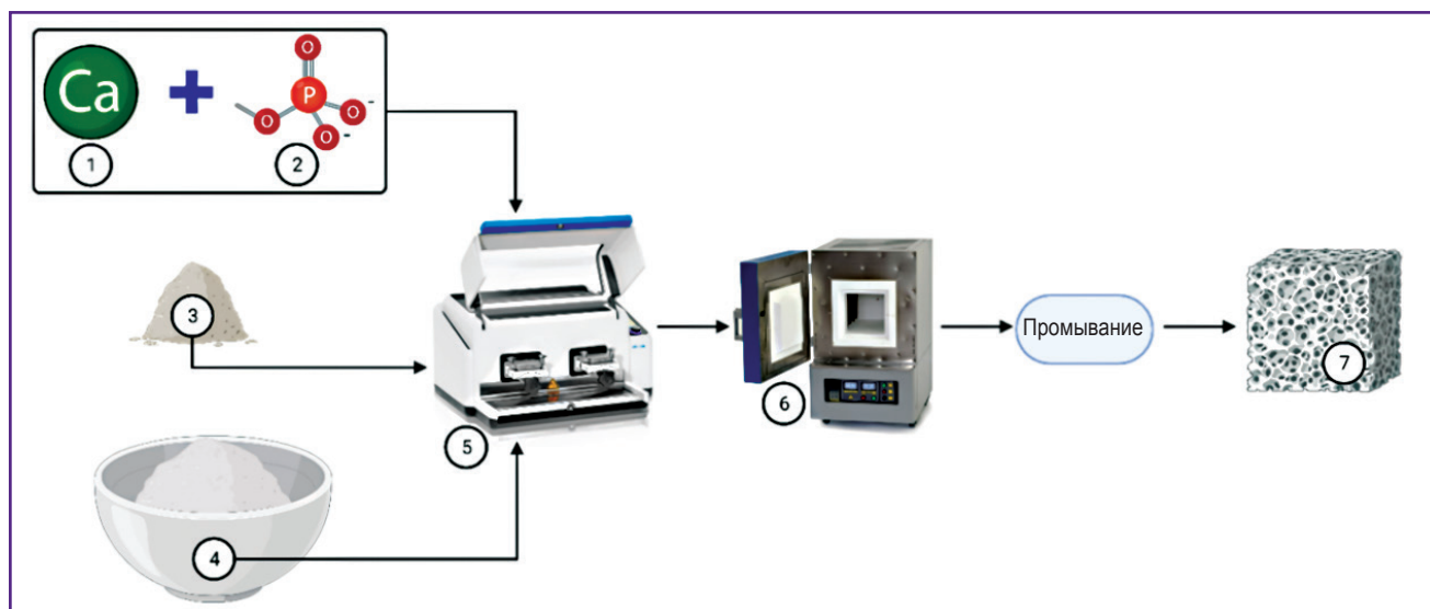
Рис. 1. Схема твердофазного способа получения гидроксиапатита:
